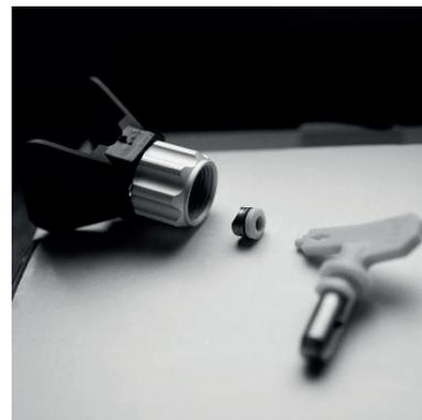
3. La buse doit être insérée dans le couvercle aussi loin que possible, en s'insérant parfaitement dans la tige de la buse.
